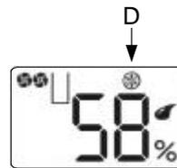
Die in das Gerät eingebaute Heißgas Abtauautomatik schaltet bei Bedarf den Abtauzyklus ein.
