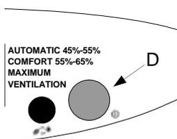
Schalten Sie das Gerät durch Betätigung der „Ein/Aus“ Taste D aus.
