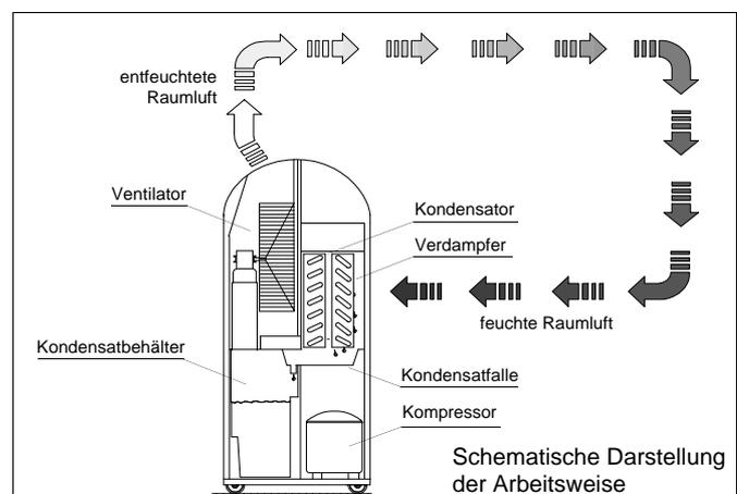
Am **Kondensator** (Wärmetauscher) wird die entfeuchtete, abgekühlte Luft wieder erwärmt und mit einer Temperatur von ca. 5 Grad über der Raumtemperatur wieder ausgeblasen.
