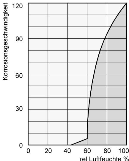
Es wird ersichtlich, daß die Korrosionsgeschwindigkeit unter 50% relativer Luftfeuchte (r. F.) unbedeutend und unter 40 % r. F. zu vernachlässigen ist. Ab 60 % r. F. steigt die Korrosionsgeschwindigkeit stark an. Diese Grenze für Feuchtigkeitsschäden gilt auch für viele andere Materialien z.B. pulverförmige Stoffe, Verpackungen, Holz oder elektronische Geräte.
