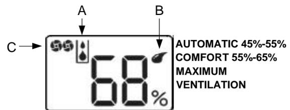
6. Wählen Sie in den Betriebsarten COMFORT und MAXIMUM mit der Taste „Ventilatorstufe“ eine der beiden Ventilatorstufen.
