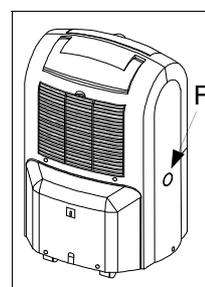
1. Brechen Sie mit einem geeigneten Werkzeug die Abdeckung F des Anschlußstutzens aus der Gerätewand.
