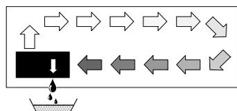
Der Luftstrom wird auf seinem Weg durch bzw. über den Verdampfer bis unter den Taupunkt abgekühlt. Der Wasserdampf kondensiert und wird in einer Kondensatfalle gesammelt und abgeführt
